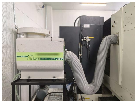
设备自带油雾净化装置
